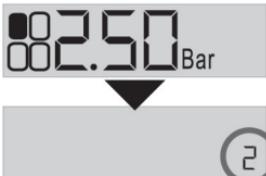
在显示器正常运行模式下，长按E键约3秒可进入显示器设置索引界面，按(S)键将索引号切换到显示“2”表示索引界面2。
