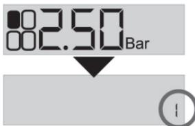
在显示器正常运行模式下，长按E键约3秒可进入显示器设置索引界面，显示“1”表示索引界面1，按S键可切换菜单。
